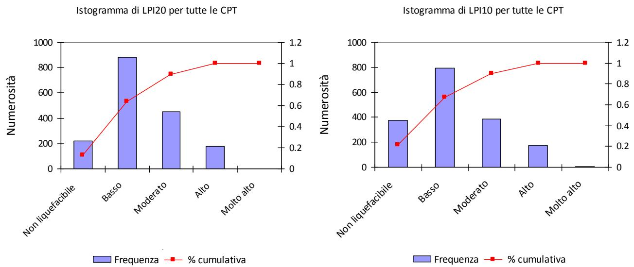
Figura 3 – Istogrammi di frequenza dei valori di  $I_L$  (LPI) per  $z_{crit} = 20$  m e  $z_{crit} = 10$  m calcolati utilizzando le prove penetrometriche a punta meccanica (CPTm) e elettrica (CPTe)
