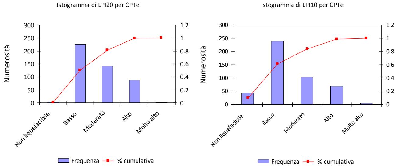
Figura 2 – Istogrammi di frequenza dei valori di  $I_L$  (LPI) per  $z_{crit} = 20$  m e  $z_{crit} = 10$  m calcolati utilizzando prove penetrometriche a punta elettrica (CPTe)
