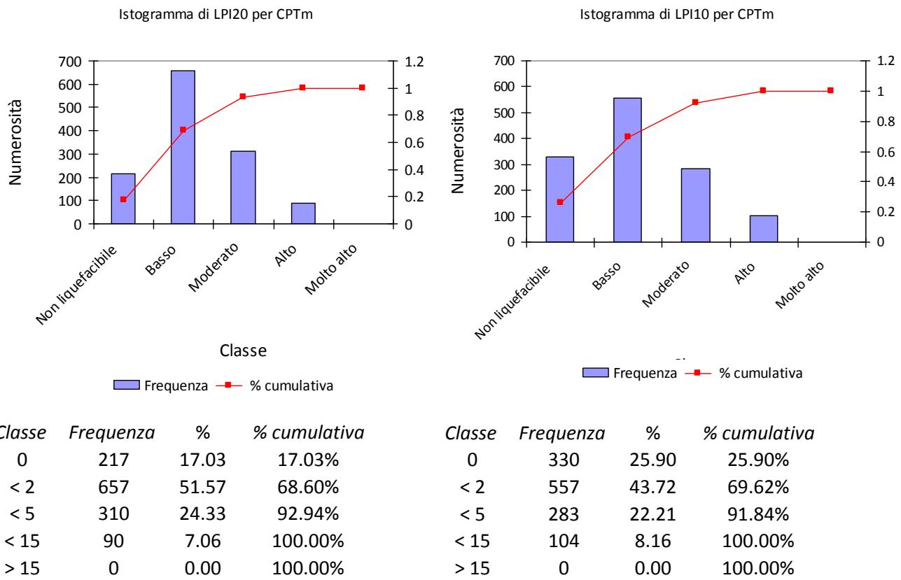
Figura 1 – Istogrammi di frequenza dei valori di  $I_L$  (LPI) per  $z_{crit} = 20$  m e  $z_{crit} = 10$  m calcolati utilizzando prove penetrometriche a punta meccanica (CPTm)
